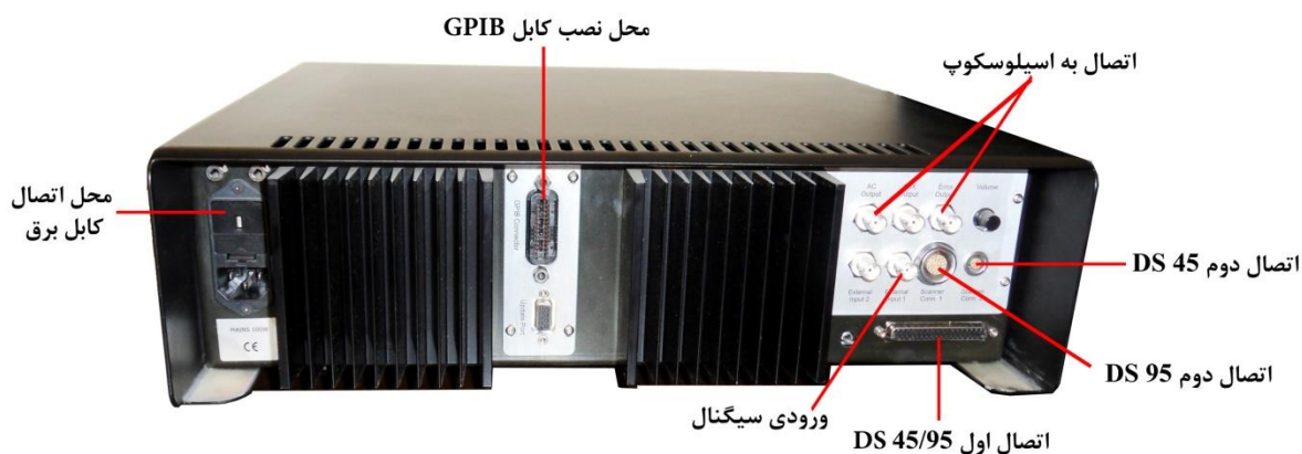
شکل ۳. نمای پشت کنترلر مدل C-26
