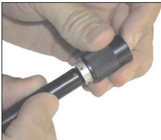
شکل ۱۵. فشردن دکمه‌ی پشت میله‌ی مغناطیسی کوتاه
