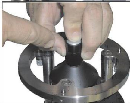
شکل ۱۶. قراردادن میله‌ی مغناطیسی کوتاه روی پنجره‌ی روبش‌گر
