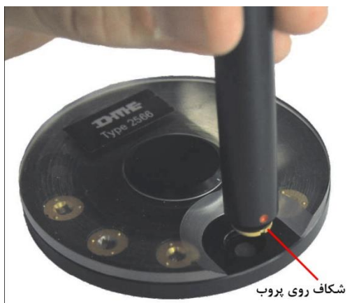
شکل ۱۳. قرار دادن میله‌ی مغناطیسی بلند روی پروب
