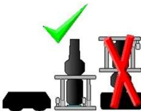
شکل 5: نحوه‌ی صحیح (چپ) و اشتباه (راست) قرار دادن روبش‌گر.
