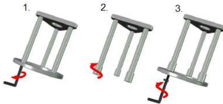
شکل 1: نحوه‌ی اتصال تنظیم‌کننده‌های ارتفاع Z به نگه‌دارنده‌ی روبش‌گر سری DS-95.
