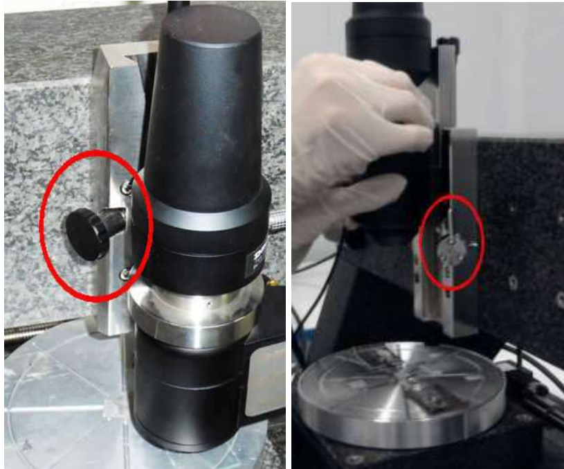
شکل 8. قفل روبش‌گر در برخی سری‌ها به صورت اهرم (راست) و در برخی دیگر به صورت پیچ (چپ) است.
