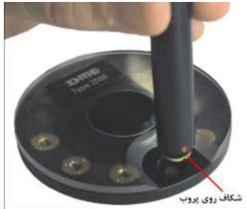
شکل 16. قرار دادن میله‌ی مغناطیسی بلند روی پروب
