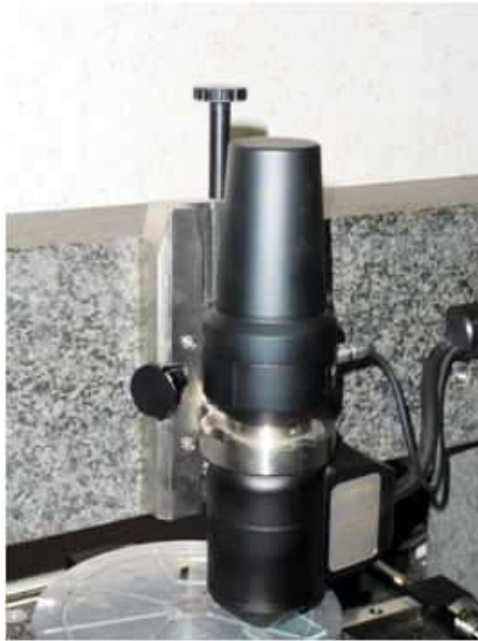
شکل 7. تنظیم فاصله روبش گر از سطح میز، به کمک پیچ فوکوس
