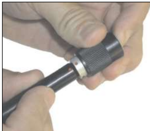
شکل 18. فشردن دکمه‌ی پشت میله‌ی مغناطیسی کوتاه
