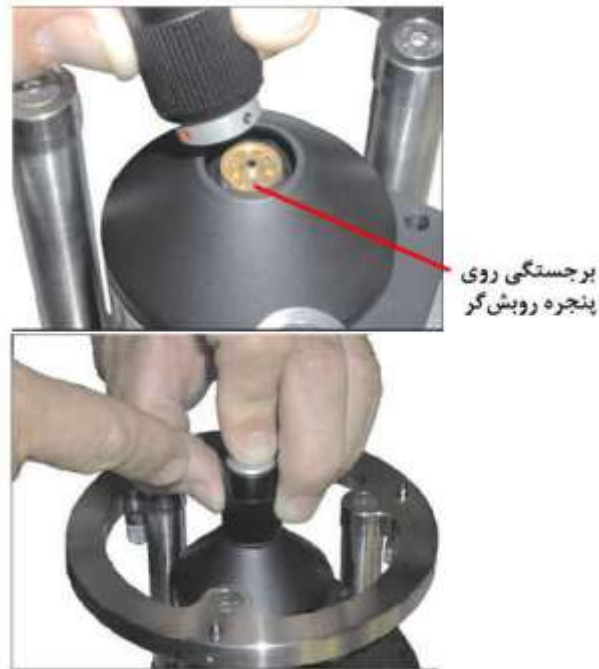
شکل 19. قراردادن میله‌ی مغناطیسی کوتاه روی پنجره‌ی روبش‌گر
