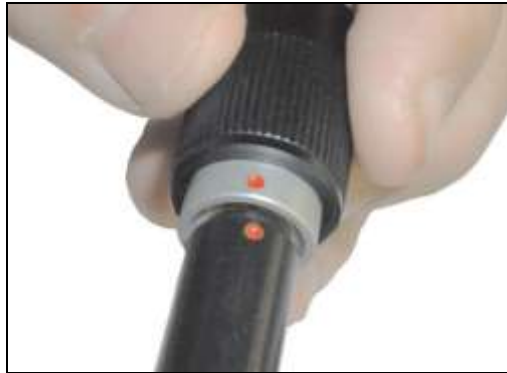
شکل 17. قرار دادن میله‌های مغناطیسی بلند و کوتاه روی هم
