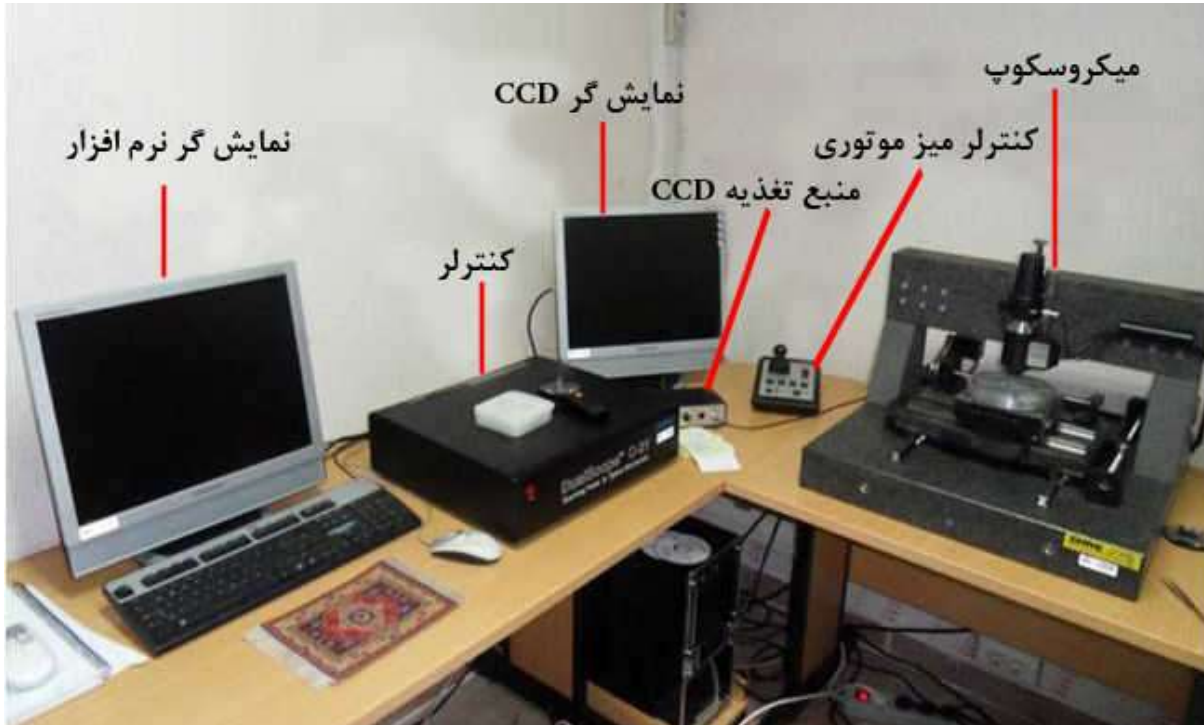
شکل 1. اجزای اصلی میکروسکوپ پروبی روبشی
