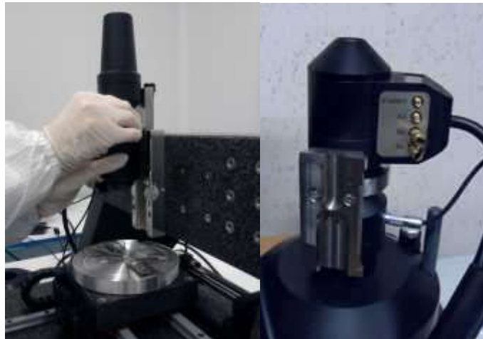
شکل 9. نحوه‌ی برداشتن روبش‌گر (راست) و برگرداندن روی پایه (چپ)
