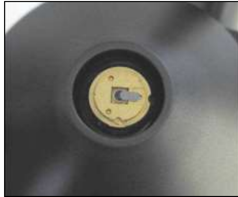
شکل 20. پروب قرار گرفته روی پنجره‌ی روبش‌گر
