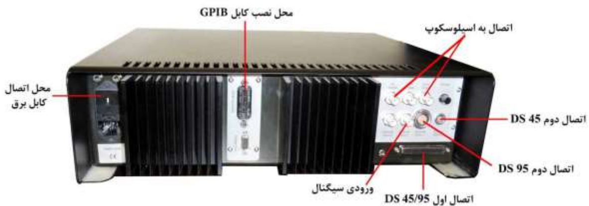
شکل 3. نمای پشت کنترلر مدل C-26
