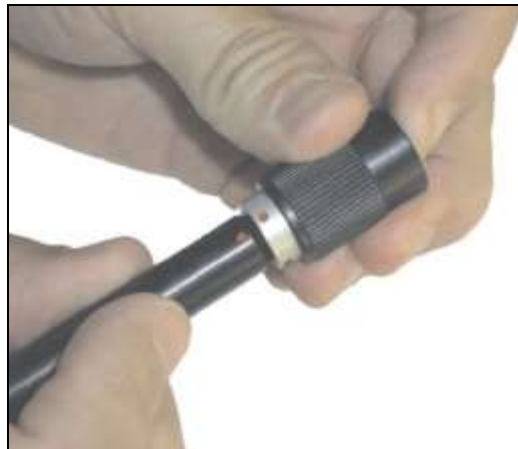
شکل 17. فشردن دکمه‌ی پشت میله‌ی مغناطیسی کوتاه
