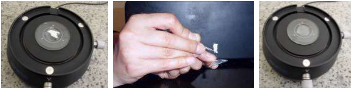
شکل 10. چسباندن چسب دو طرفه در وسط صفحه‌ی شیشه‌ای (راست)، کندن پوسته‌ی نازک روی یک CD حاوی اطلاعات (وسط) و چسباندن آن روی چسب دوطرفه (چپ)
