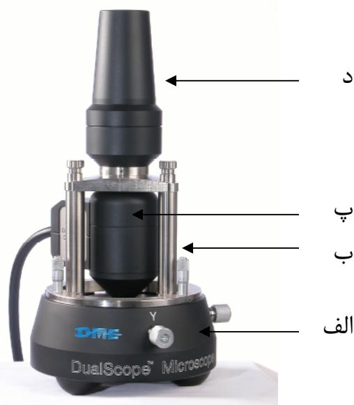
شکل ۹: نمونه‌ای از مجموعه الف) میز  $y, x$ , ب) سه‌پایه نگهدارنده، پ) روبشگر و د) دوربین CCD.
