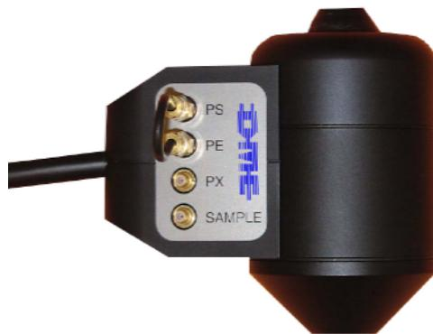
شکل ۸ : نمونه‌ای از روبشگر. پروب (کانتی‌لیور) در انتهای پایینی آن نصب می‌شود.
