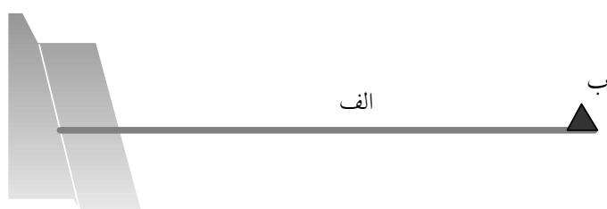
شکل ۳: الف) نمایی از کانتیلیور (b) به همراه سوزن ساده‌ترین نقشه‌ای که SPM به وجود می‌آورد، نقشهٔ توبوگرافی (سه بعدی) سطح است. نقشه‌های دیگری هم قابل دستیابی است که مناطقی از سطح که به صورت فیزیکی یا شیمیایی از بقیه نقاط متمایز هستند را نشان می‌دهند و اطلاعاتی در مورد خواص الکتریکی، مکانیکی، مغناطیسی، اپتیکی و سایر خواص ماده به دست می‌دهند.
