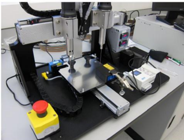
شکل ۳-۴: چاپگر زیستی ایم ایم ایکس نوووژن، ساخت شرکت آرگانووو
