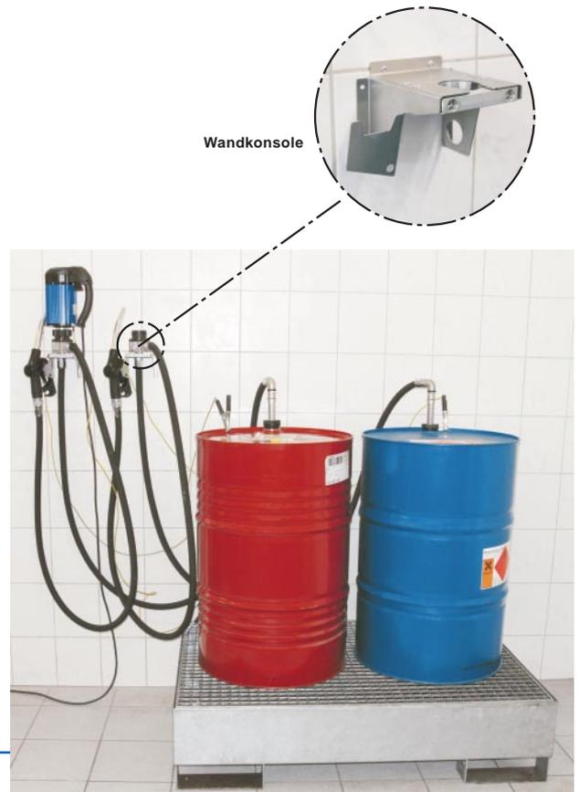
Saug- und Druckschlauchgarnitur mit einer Länge von jeweils 2,50 Meter bieten höchstmögliche Flexibilität für verschiedene Anwendungen. Das leichte und handliche Edelstahlsaugrohr sowie die hohe Saugleistung erlauben die Entleerung eines Fasses bis auf kleinste Restmengen. Ein Umbau von der Ausführung für die Wandmontage auf die Ausführung Fasspumpe ist mit wenigen Handgriffen möglich.
